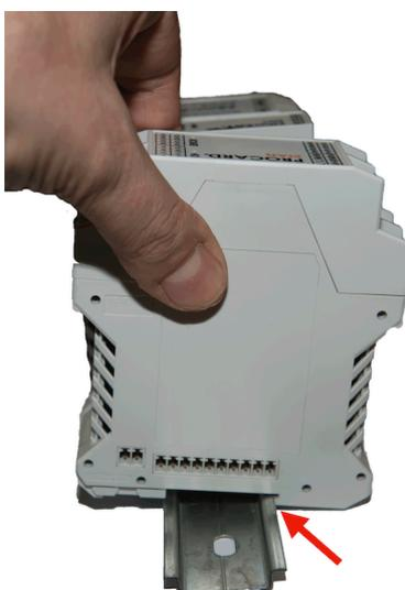
Figura 7: Inserimento del modulo in guida DIN (parte 1)
