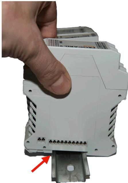
Figura 8: Inserimento del modulo in guida DIN (parte 2)
