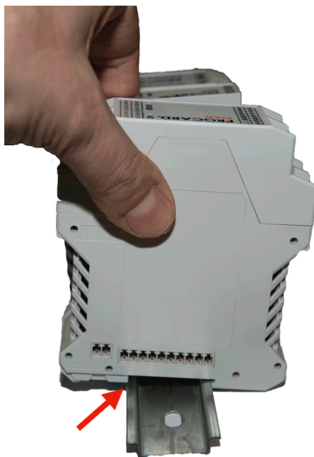
Figura 11: Inserimento del modulo in guida DIN (parte 2)
