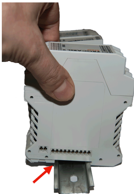
Figura 9: Inserimento del modulo in guida DIN (parte 2)
