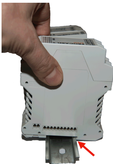
Figura 8: Inserimento del modulo in guida DIN (parte 1)
