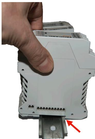
Figura 8: Inserimento del modulo in guida DIN (parte 1)
