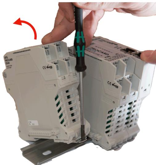
Figura 12: Rimozione del modulo da guida DIN (parte 2)
