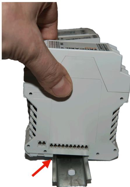
Figura 9: Inserimento del modulo in guida DIN (parte 2)
