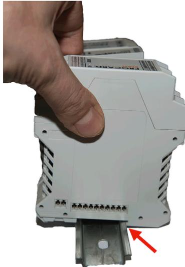
Figura 11: Inserimento del modulo in guida DIN (parte 1)
