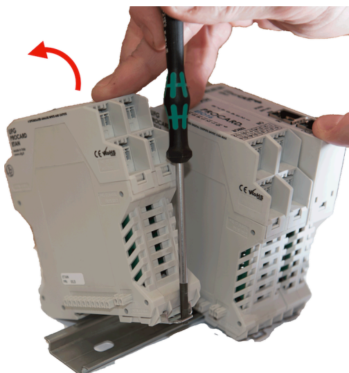
Figura 15: Rimozione del modulo da guida DIN (parte 2)
