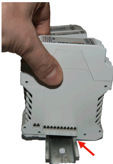
Figura 11: Inserimento del modulo in guida DIN (parte 1)
